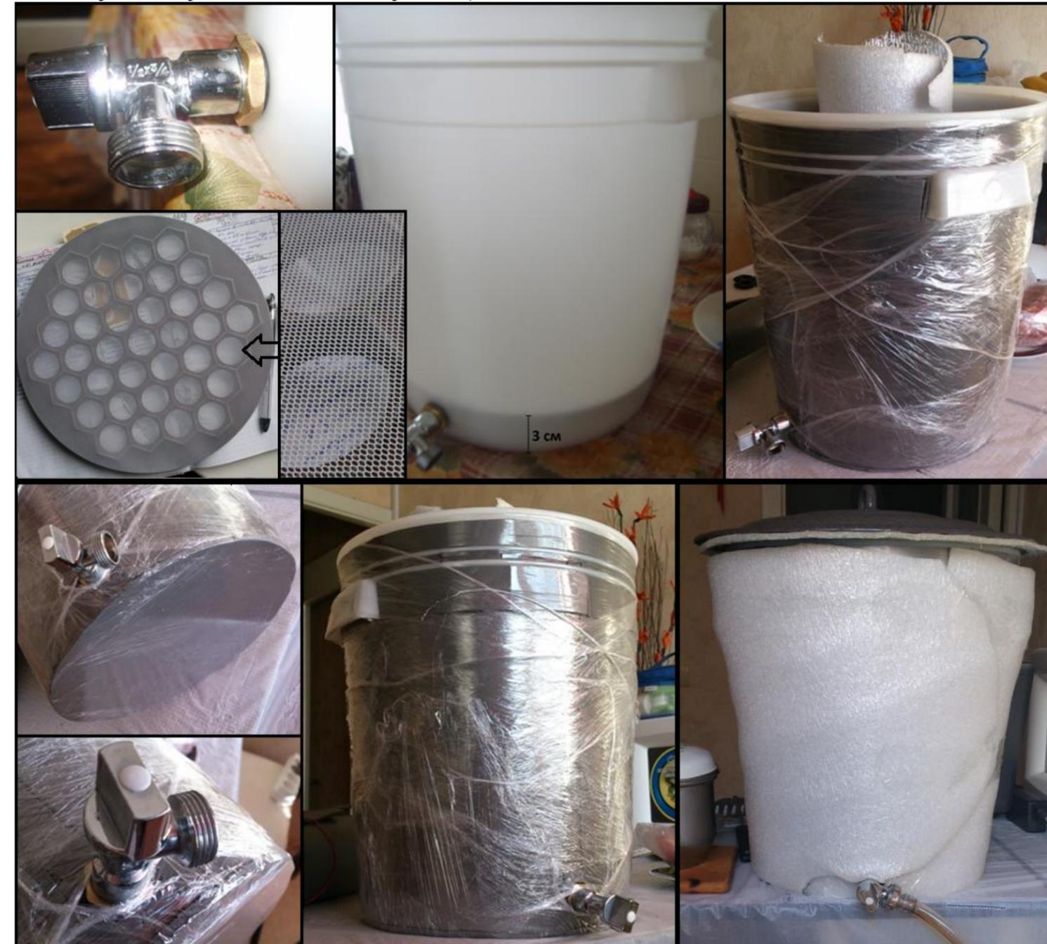
1) Обтянула изолоном (4мм, серый, очень плотный), в некоторых местах посадила на клей, щели заткнула ошметками изолонa и залила клеем.
