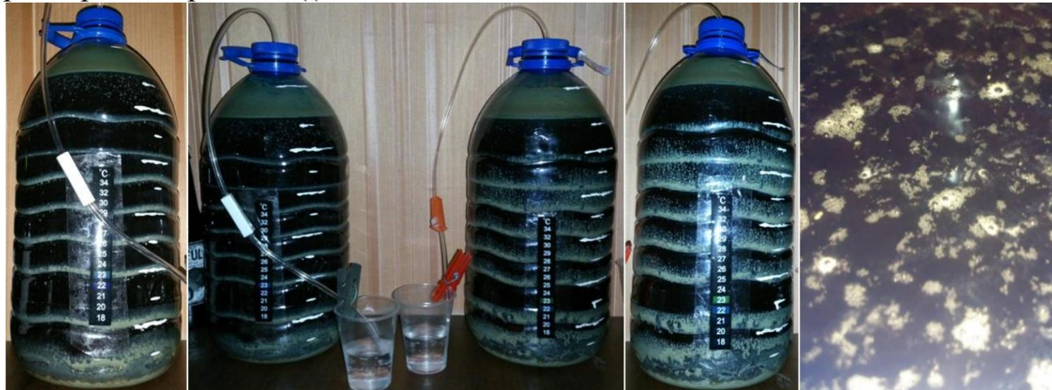
...итак.... включаю рециркулятор (за 40 минут до всех манипуляций), делаю фото ферментера, протираю его поверхность перекисью, и лезу за отбором пробы на плотность (трубку протерла спиртом)...
